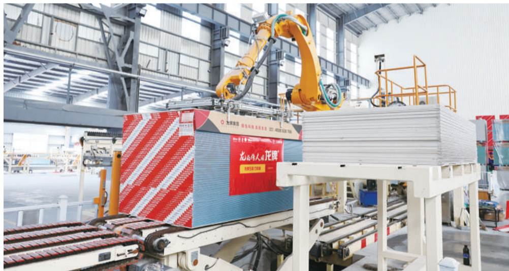
北新集团建材股份有限公司滨州分公司年产6000万平方米纸面石膏板及1万吨轻钢龙骨生产线项目。(资料图)
