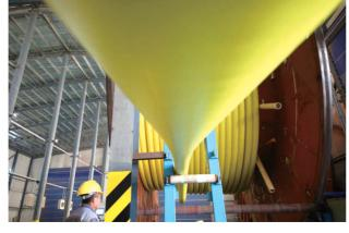
自主研发、制造国内首条海 洋用非粘结管道以来,已累 计生产各种海洋软管 500余
