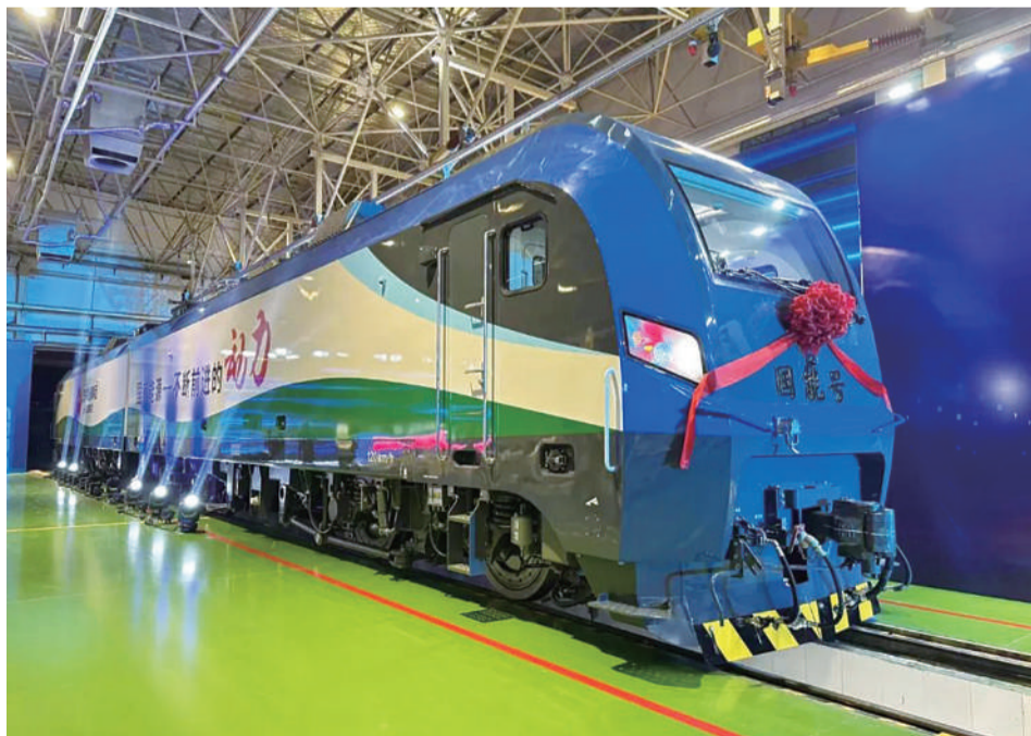
机车应用了全球首创大功率碳化硅变流器,相比于传统技术,功率密度超过1.8
