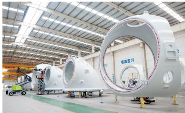
“就像这个轮毂,有油漆层、锌层和防滑砂涂层,三道涂层质量标准是不一样的,而且我们是控制到微米级的,现在我们就是通过先进的设备技术,保证涂层的质量。通过喷砂机器人、喷锌机器人、喷涂机器人,
