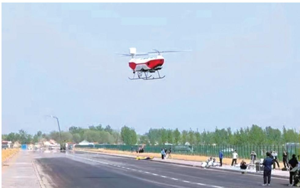
无人驾驶飞机简称“无人机”，是利用无线电遥控设备和自备的程序控制装置操纵的不载人飞机。从技术角度定义可以分为：无人固定翼飞机、无人垂直起降飞机、无人飞艇、无人直升机、无人多旋翼飞行器、无人伞翼机等。
