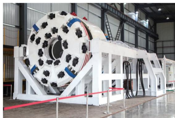
5月20日，由清华大学和中国中铁工业所属中铁科工集团联合研制的世界首台掘爆机试验装备目前完成了空心刀盘掘进、超前预裂处理后空心刀盘掘进和全断面刀盘掘进三种工况下的掘进试验，该装备即将进入推广应用阶段。
